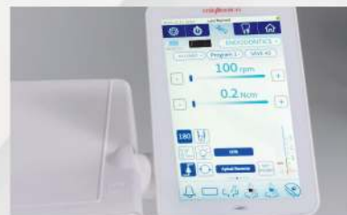
OTR – MODUS UND DREHMOMENT Dank des speziellen Bildschirms kann man zwischen OTR und TORQUE REVERSE wählen.
