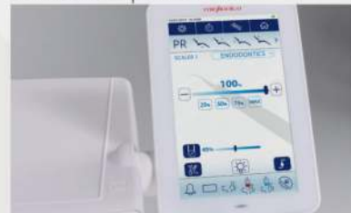
ZEG In diesem speziellen Bereich können Sie: • arbeiten in den Modi: Endo, Scaling, Perio • der Fluss der Peristaltikpumpe steuern • proportionalmodus aktivieren
