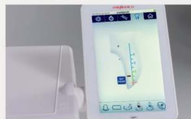
MANUELLER APEXLOKATOR Der Apex-Lokator kann auch im manuellen Modus verwendet werden, indem die externe Sonde an das Bedienfeld angeschlossen wird. Durch Drücken der entsprechenden Taste im oberen Menü wird auf dem Display ein Bildschirm mit einem farbigen Balken angezeigt, der aufleuchtet und ein akustisches Signal ausgibt, um anzuzeigen, dass Sie sich dem Scheitelpunkt nähern.
