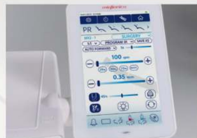
ABLATORE In questa sezione dedicata è possibile: • operare in modalità: Endo, Scaling, Perio; • gestire il flusso della pompa peristaltica; • attivare la modalità proporzionale.
