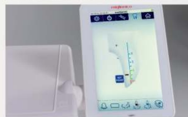
RILEVATORE APICALE MANUALE Il rilevatore apicale può essere utilizzato anche in modalità manuale attaccando la sonda esterna al pannello operatore. Premendo il tasto dedicato dal menù in alto, sul display comparirà una schermata con una barra colorata che si illuminerà e emetterà un segnale sonoro per indicare l'avvicinamento all'apice.
