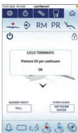
6. Al final del proceso, el equipo emitirá 3 señales sonoras distintas. Para reanudar el trabajo, presione OK.
