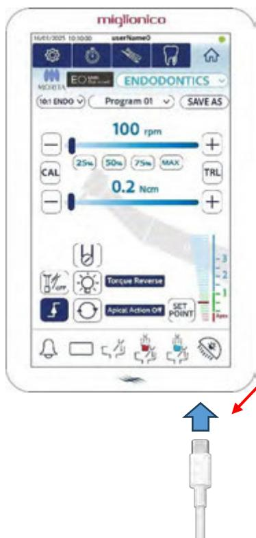
Seleccionar el micromotor Morita y conectar el cable de la sonda suministrado en el conector type-C ubicado debajo del panel táctil del operador.
