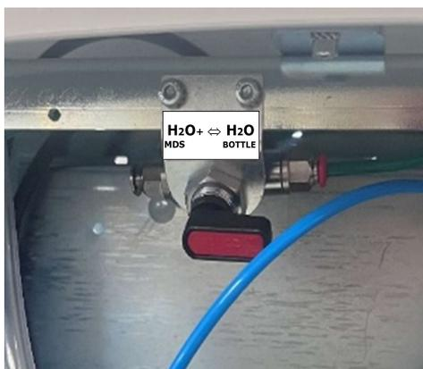
Variante con presenza del sistema di disinfezione automatico **MDS**, o **MDS+** e sistema di alimentazione separata con bottiglia.
