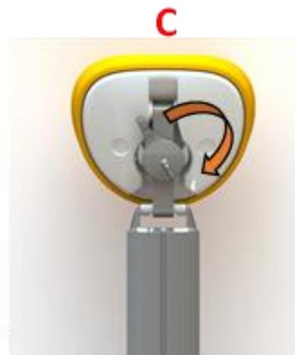
Für die senkrechte Bewegung ziehen Sie die Kopfstütze, um diese nach oben zu verschieben; drücken Sie die Taste, um die Kopfstütze nach unten zu verschieben.
