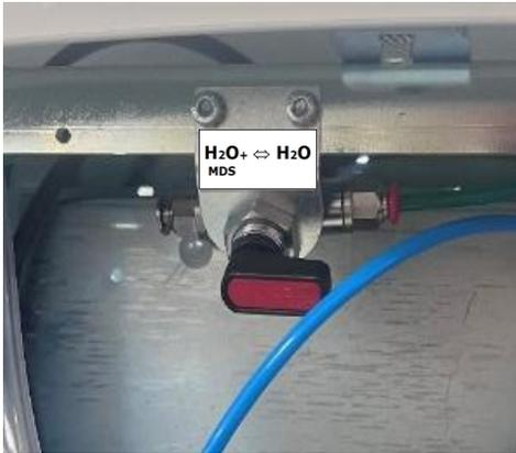
Ausführung mit automatischem **MDS- oder MDS+-Desinfektionssystem**.
