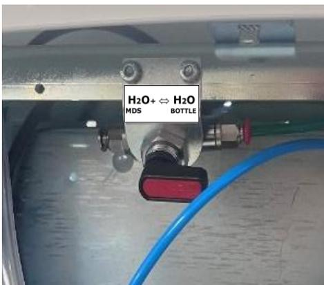
Ausführung mit automatischem **MDS- oder MDS+-Desinfektionssystem**
