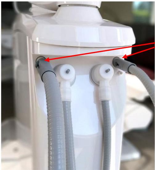
Entfernen Sie den Schutzcover und stecken Sie die Leitungen in die entsprechenden Düsen ein.
