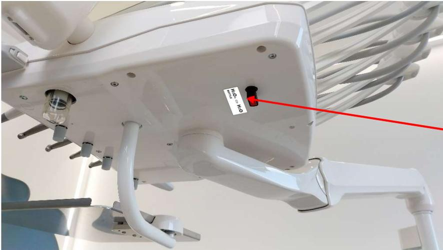
Variante con presenza del sistema di alimentazione separata con bottiglia.
