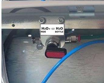
Вариант с наличием системы дезинфекции **MDS** или **MDS+** и автономной системы подачи дист. воды
