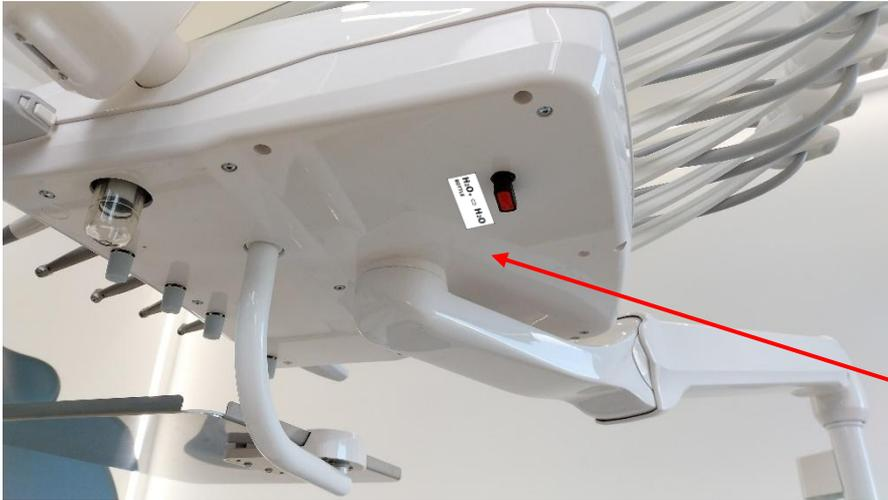
Variante avec présence d'un système d'alimentation séparé avec bouteille.
