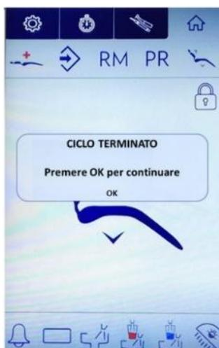
6. Al final del proceso, el equipo emitirá 3 señales sonoras distintas. Para reanudar el trabajo, presione **OK**.
