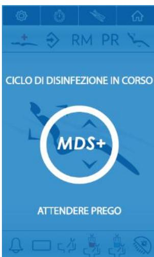
5. Una vez iniciado el ciclo, el equipo emitirá señales sonoras intermitentes cada 5 segundos y la palabra **ON** parpadeará. El proceso consta de dos fases y tiene una duración total de aproximadamente 10 minutos. La primera fase realizará dos ciclos de lavado al 3%, mientras que la segunda fase realizará dos ciclos de lavado al 1%. Durante todo el ciclo de desinfección intensiva, no se puede utilizar el equipo.
