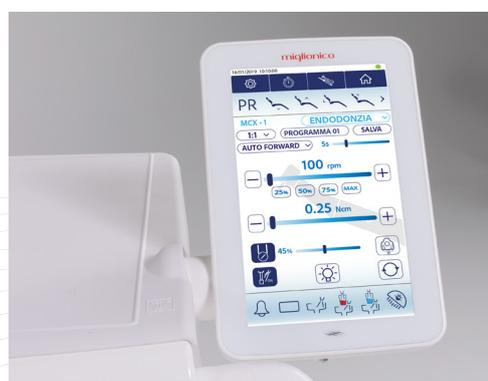
motore MX2 Bien Air e pompa peristaltica può eseguire operazioni di chirurgia, endodontia e conservativa. L'MX2 ha una coppia regolabile da 0,3 Ncm ad oltre 70 Ncm a seconda del manipolo
